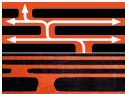
Rys. 1. Dystrybucja gazów, rozgrzanego powietrza i pary wodnej pod powierzchnią papy. Ogólna powierzchnia kanałów wentylacyjnych to 50% całkowitej powierzchni papy.
